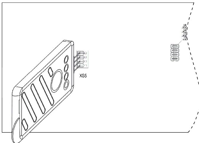
Рис. 1 Подключение USB-программатора к плате ППКОП «Циркон-3...-8»
