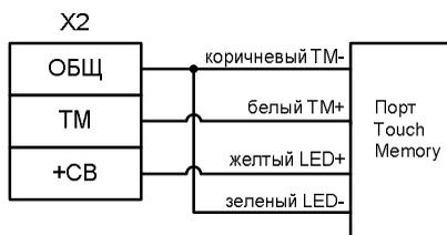
Рис. 2 Схема подключения порта Touch Memory к прибору
